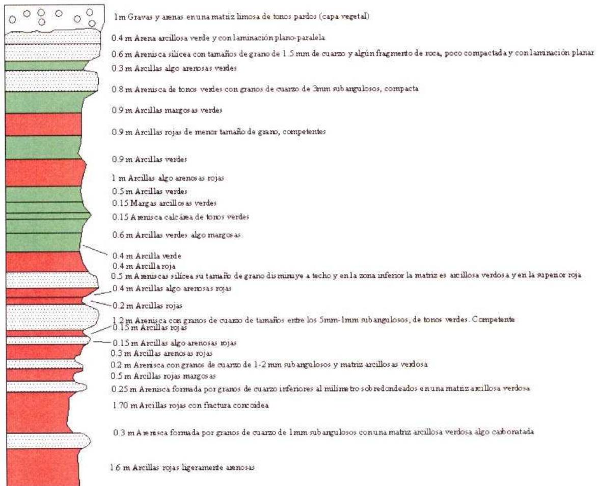
**Figura 2.-** Columna MON-2 en ella se observa las diferencias entre el tramo superior de arcillas verdosas y el inferior de arcillas rojizas.
